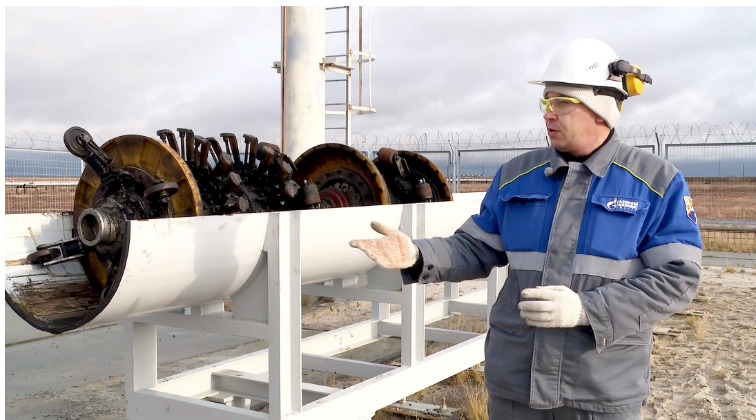
Юрий Гладков рассказывает о том, как проходит запуск аппаратов для обследования газопровода. На фото – профилемер в приёмном устройстве
